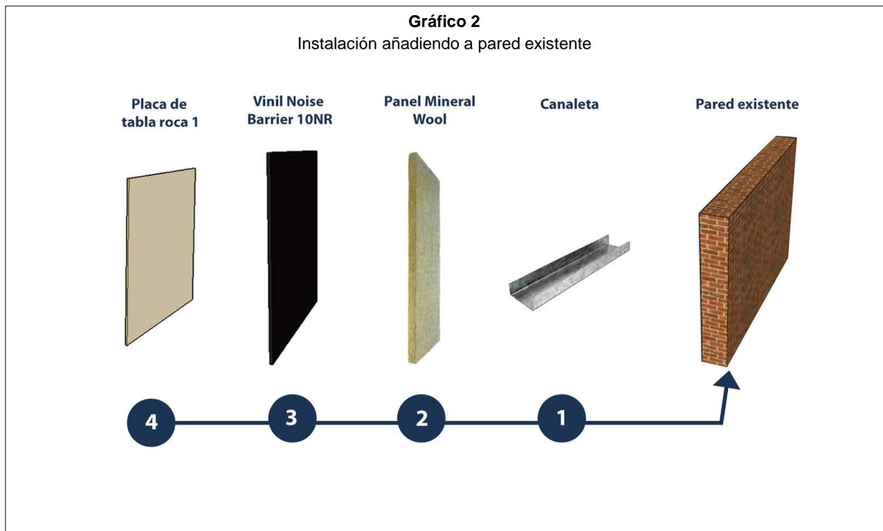
1. Instalar el bastidor metálico o canaletas sobre superficie de pared existente, procurando espacios de 1.22 x 0.61 ms.
